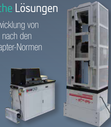
(Oben) Eine von zwei 1000-kN-Prüfmaschinen, die von Lindapter in der Forschung und Entwicklung benutzt werden
