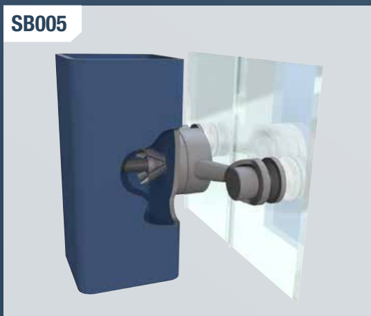
Hollo-Bolt verbindet einen Glashalter mit dem quadratischen Hohlprofil und hält die Glasfassade.
