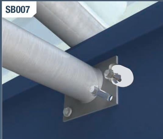
Hollo-Bolt mit hoher Klemmkraft (HCF) verbinden eine Edelstahl-Vordachkonstruktion mit einem Doppel-T-Träger der von der Rückseite unzugänglich ist (Derby Midland Station, Großbritannien).
