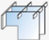
Ausnehmung der Tragstäbe im Auflagebereich um eine bestimmte Bauhöhe zu erreichen. Die Tragfähigkeit ist zu prüfen.
