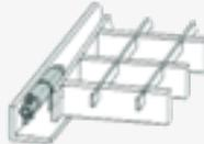
Ausführung alternativ für leichte und schwere Gitterroste, versetzt oder aufgesetzt. Der Rost kann dadurch hochgeklappt werden.
